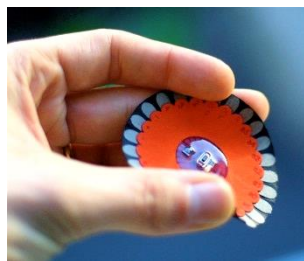
Versione flessibile di Arduino LilyPad, per applicazioni su tessuti.
